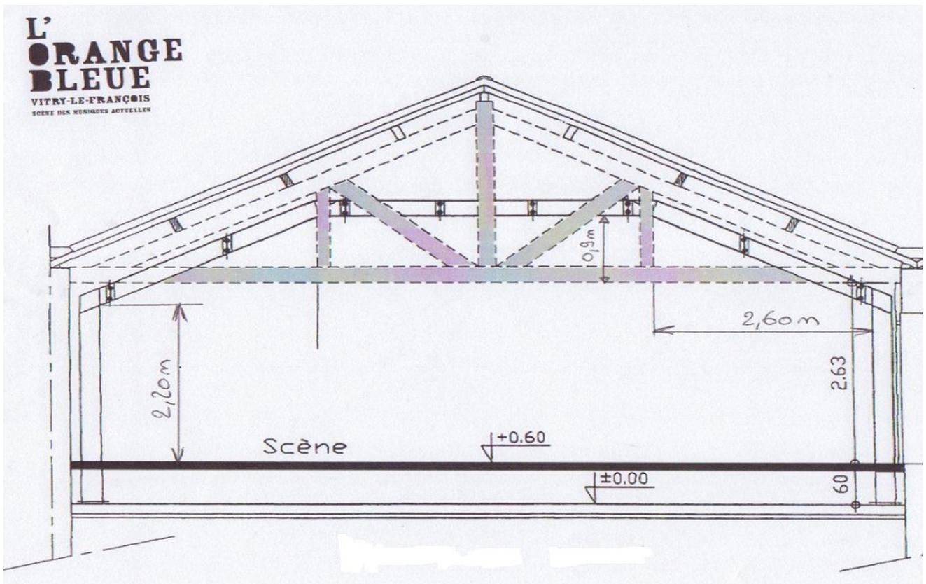
**VUE DE FACE SCENE (ouverture 8m exploitable x 7,40m de profondeur)**
